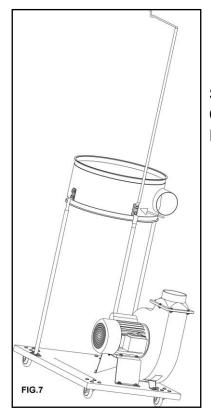
AT THIS TIME THE UPPER BAG SUPPORT BE INSTALLED ONTO THE COLLECTOR SUPPORT AS SHOWN IN FIG.7.
