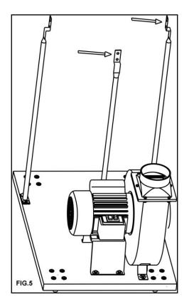
THE COLLECTOR SUPPORT CAN BE MOUNTED TO THE BASE PLATE AS SHOWN FIG.5.
