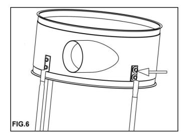
NOW ATTACH THE COLLECTOR TO THE TWO COLLECTOR SUPPORTS MAKING SURE THE SIDE HOLE IN FACING THE COLLECTOR BODY AS SHOWN IN FIG.6.
